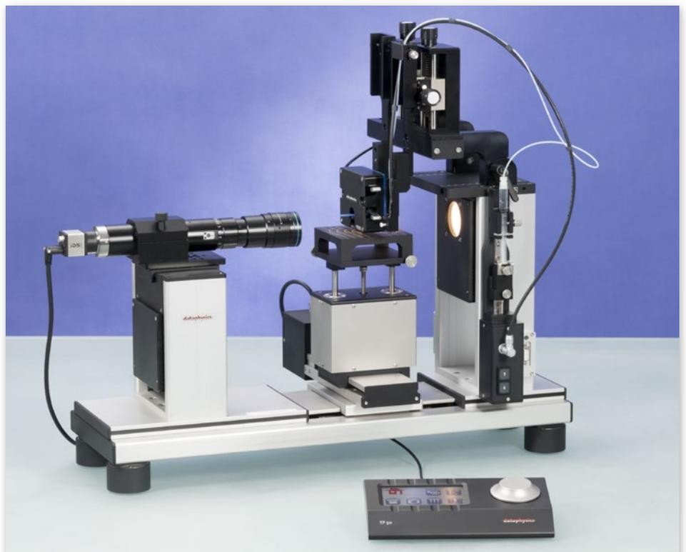
Das Kontaktwinkelmessgerät OCA 200 von DataPhysics Instruments wurde speziell entwickelt, um kleinste Tropfen auf Substraten zu vermessen.
