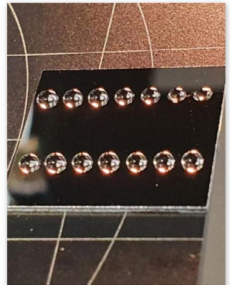
Programmerroutinen erlauben die automatische Dosierung mit Spritzen (s. Bild) oder dem PDDS.
