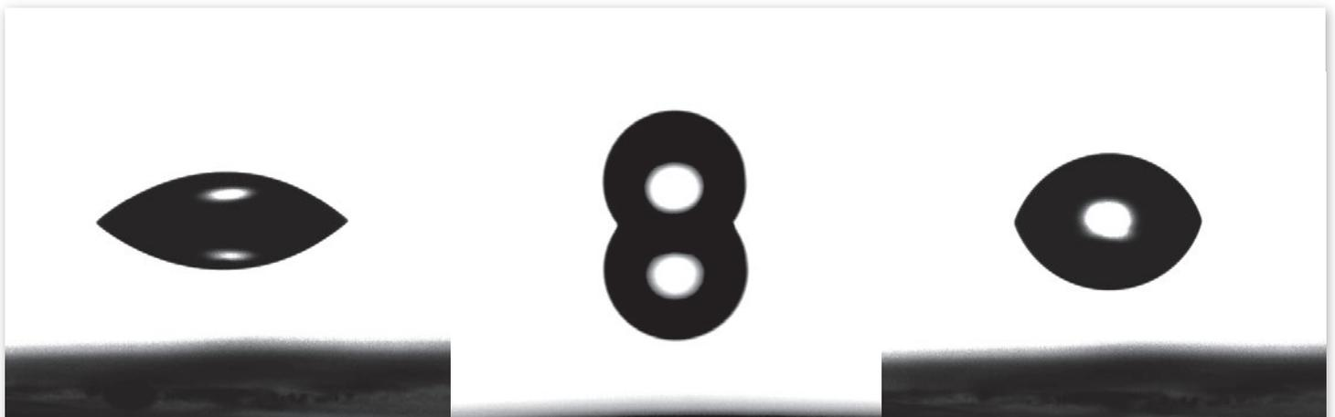
Auf unbehandeltem Platin bildet sich ein Kontaktwinkel von circa  $40^\circ$  aus (links). Die Platinoberfläche beschichtet mit SAMs aus Lösung, bildet einen Kontaktwinkel von  $126^\circ$  aus (Mitte). Die mit SAMs aus der Dampfphase beschichtete Platinoberfläche hat einen Winkel von  $72^\circ$  (rechts).
